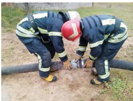
134 pav. Įsiurbiamųjų žarnų sujungimas
