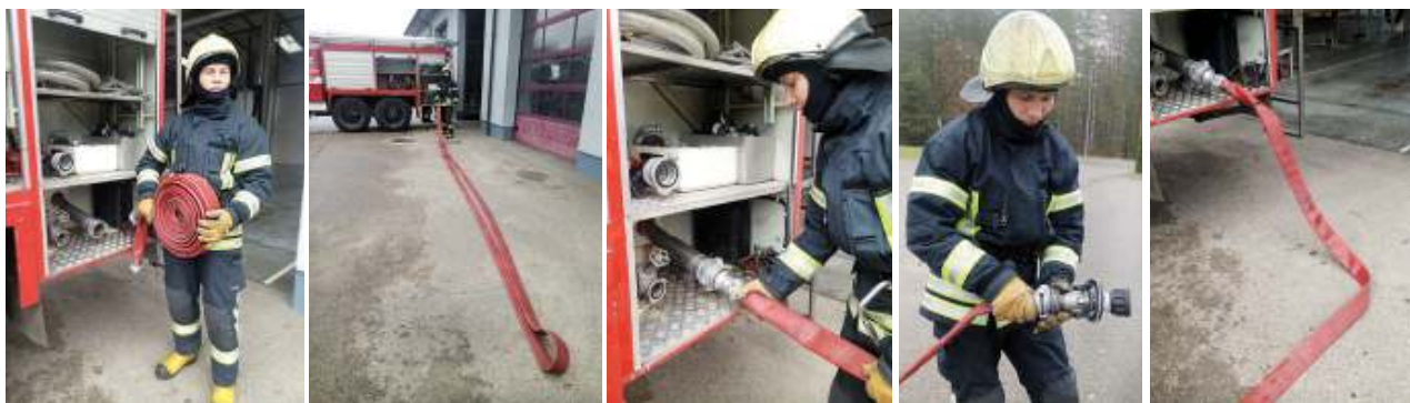
99 pav. Žarnos išvyniojimas, prijungimas prie automobilinės cisternos ir švirkšto
