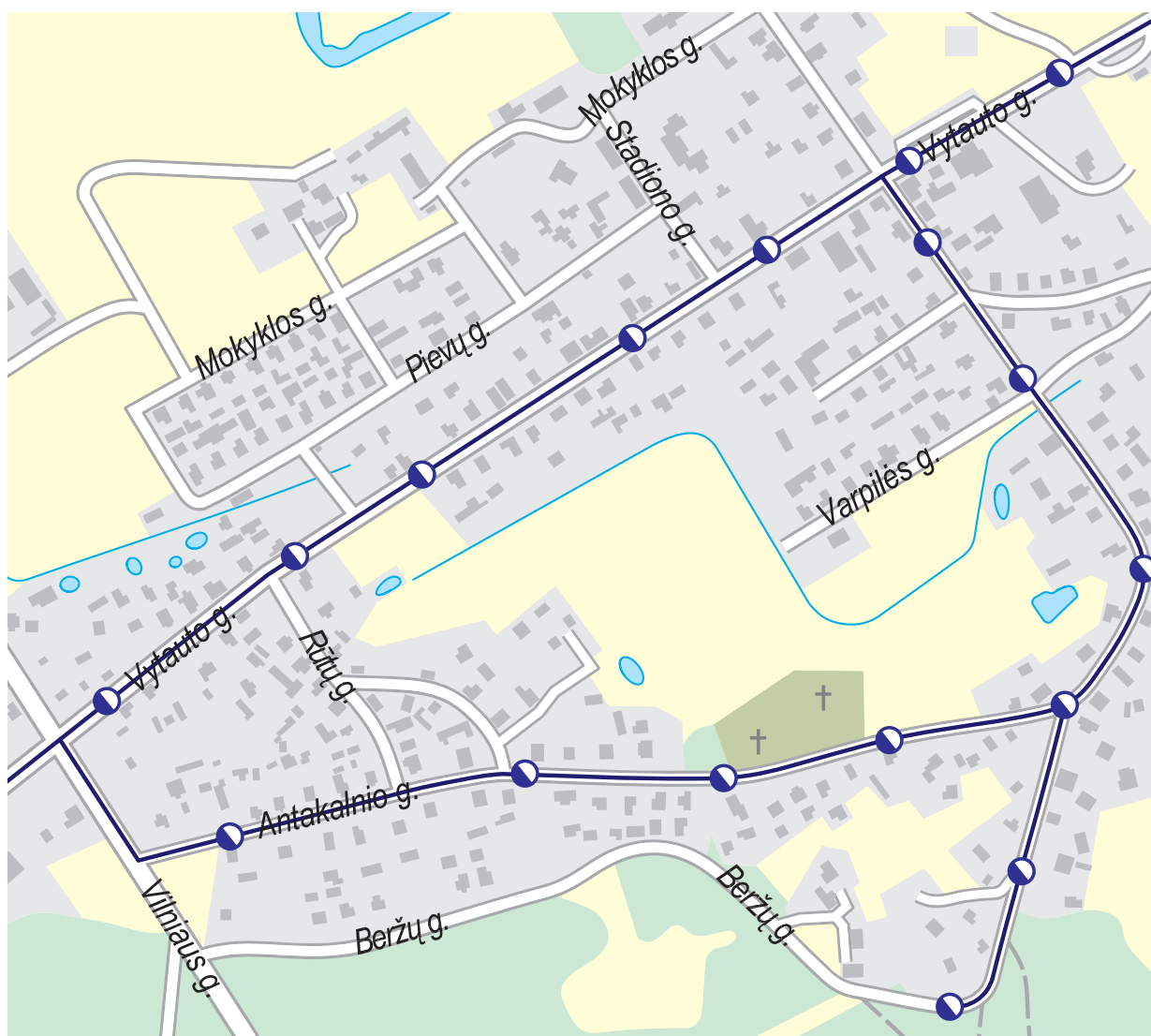
82 pav. Žiedinė ir aklinė vandentiekio sistema
