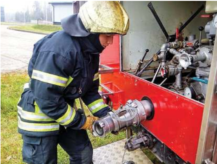
144 pav. Vandens surinktuvo prijungimas
